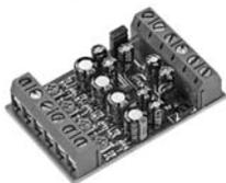
Усилитель – разветвитель **AVD104NT** – распределяет видеосигнал от одного источника на четыре выхода с возможностью независимой настройки коэффициента усиления каждого канала. **AVD104NT** разработаны специально для построения видеодомофонных систем в многоквартирных домах. Сквозной видеовыход, регулируемое усиление и возможность установки входного сопротивления усилителя (75 Ом - High) позволяют легко и без лишних затрат построить систему видеонаблюдения со множеством потребителей.
